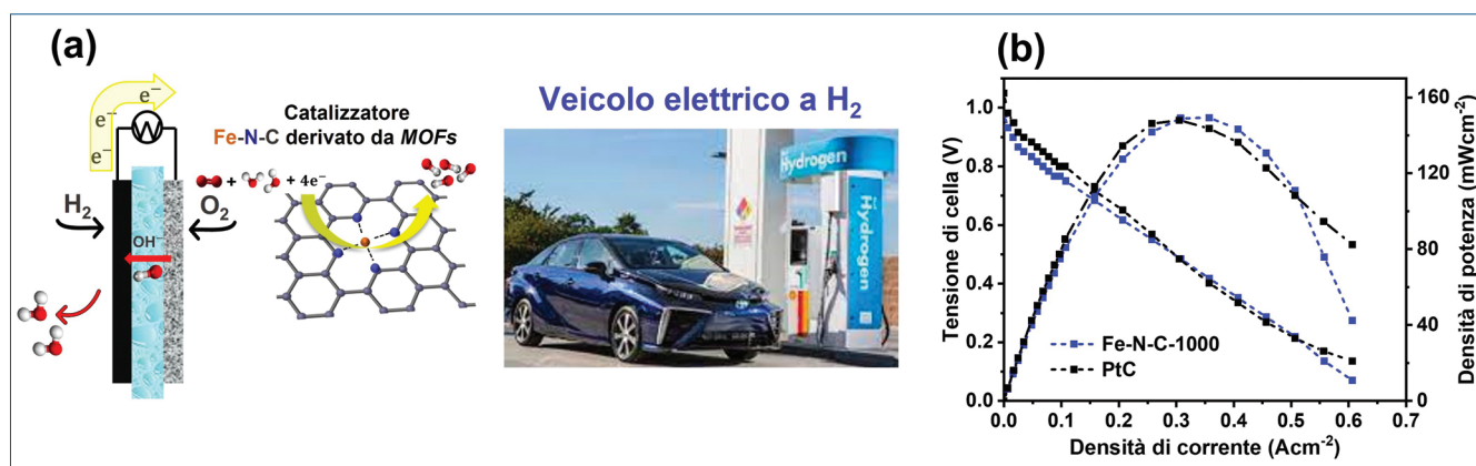
Fig. 3 - Schemi per AEMFC e veicolo elettrico (a), curva di polarizzazione e densità di potenza per una AEMFC alimentata con H_2 , utilizzando al catodo Fe-N-C-1000 o Pt/C (b)
