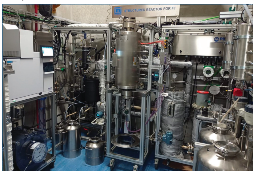
Fig. 2 - Impianto pilota per lo studio della sintesi di Fischer-Tropsch, installato al Dipartimento di Energia del Politecnico di Milano nell'ambito del progetto INTENT ( https://www.intent.polimi.it )
