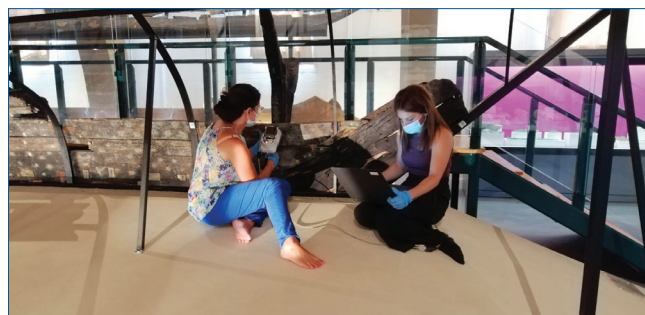
Fig. 1 - Indagini mediante spettroscopia XRF dei chiodi della nave punica conservata presso il Parco Archeologico Lilibeo-Marsala
