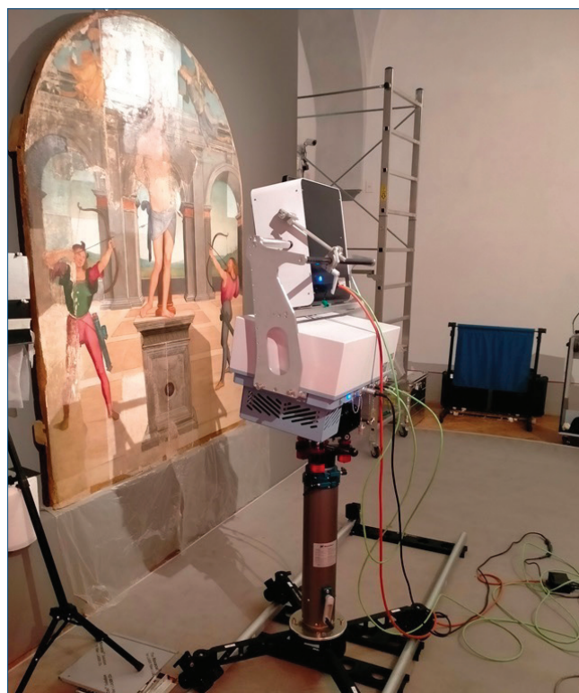
Fig. 3 - Il sistema "Bruker HI90 modificato" durante una misura di imaging iperspettrale nel medio-IR sul dipinto di Pietro Perugino "Il martirio di S. Sebastiano" (1518), in restauro presso la Galleria Nazionale dell'Umbria
