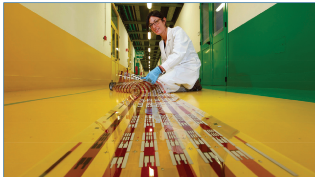
Fig. 5 - Celle fotovoltaiche polimeriche preparate al Centro Ricerche per le Energie non Convenzionali
