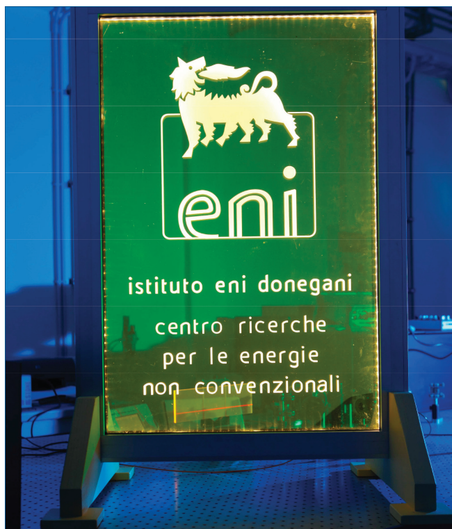
Fig. 4 - Prototipo di finestra fotovoltaica con i concentratori solari luminescenti sviluppati al Centro Ricerche per le Energie non Convenzionali
