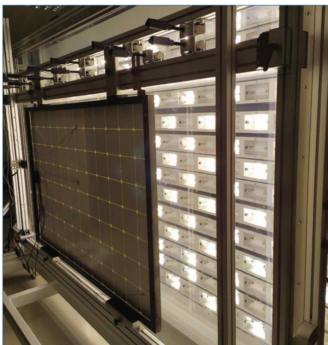
Fig. 6 - Modulo fotovoltaico esposto a Simulatore Solare di larga area
