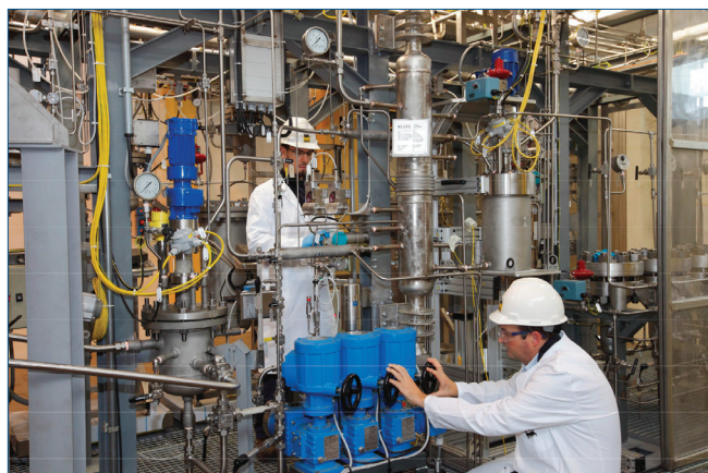
Fig. 8 - L'impianto pilota per la trasformazione della frazione organica dei rifiuti urbani (FORSU) in bio-olio
