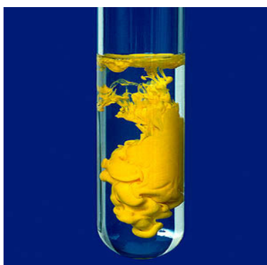
Figura 3: Precipitazione dello ioduro di piombo (II)
