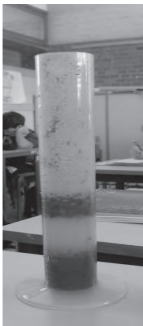
Figura 8 - Cilindro con decantazione di un terreno dopo 48 ore.
