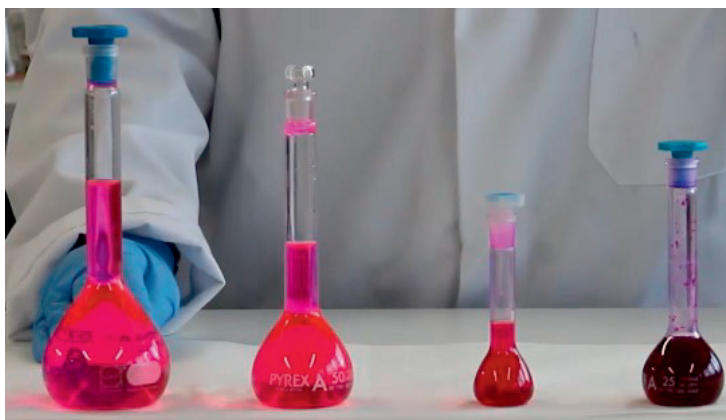
Figura 8. Soluzioni acquose di rodamina B a concentrazioni diverse dalla più concentrata a destra ( C=0.004 M) alla più diluita a sinistra ( C=0.00004 M). (foto presso il Dipartimento di Chimica e Chimica Industriale - Università di Pisa).
