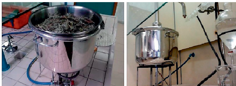
Figura 2: (a) cestello, (b) impianto finale con imbuto separatore
